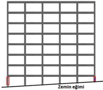
Şekil 1. Eğimli zeminde kolon boylarının farklı değerler alması
